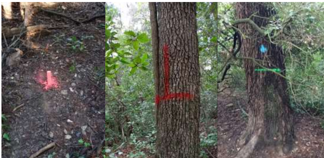
Figura 1. Imágenes del marcaje de la parcela (izquierda), marcaje del árbol más cercano al centro de la parcela, con una T invertida (centro), y marcaje de la altura donde se ha medido el diámetro normal (derecha). Fotos Lluís Comas.
